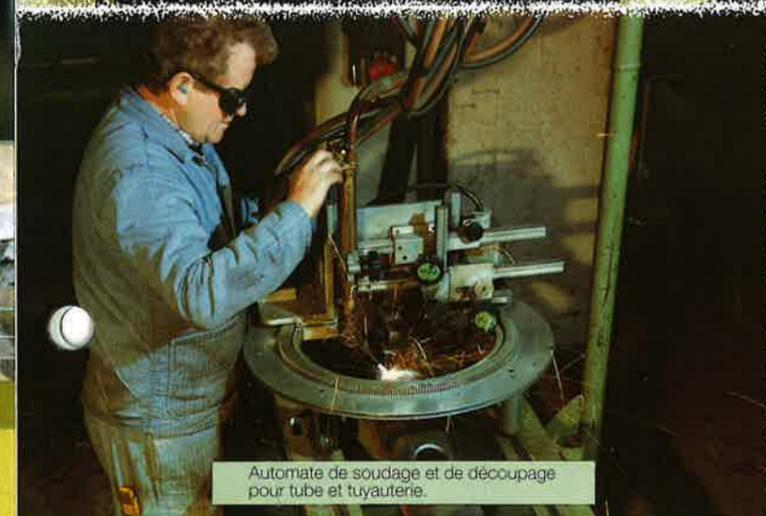
Automate de soudage et de découpage pour tube et tuyauterie.
