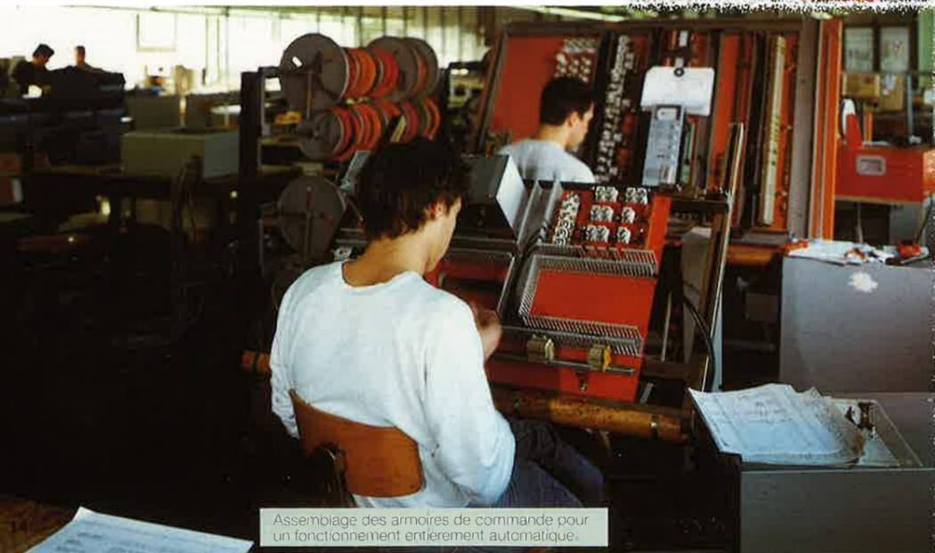
Assemblage des armoires de commande pour un fonctionnement entièrement automatique.
