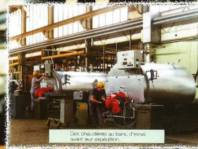
Des chaudières au banc d'essai avant leur expédition.
