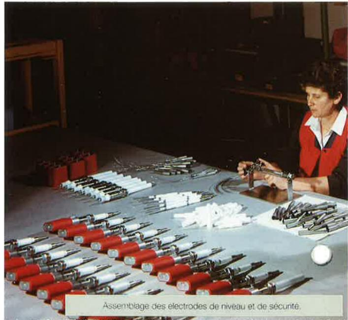
Assemblage des électrodes de niveau et de sécurité.
