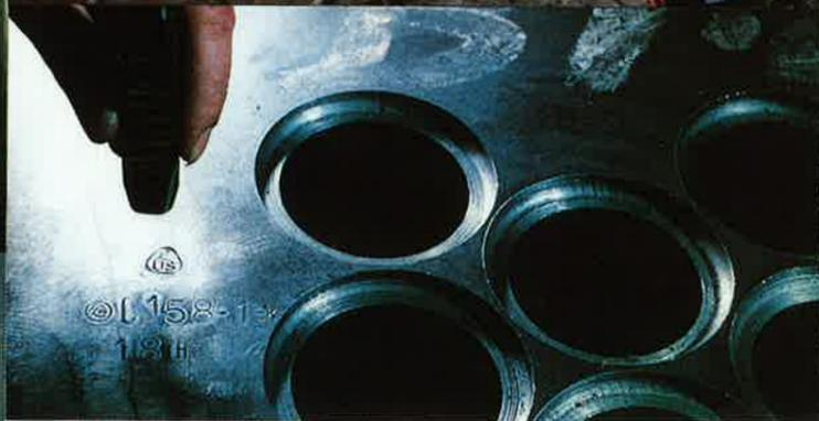
Le contrôle matière sur la chambre de réversion est indispensable car une déformation de la structure du métal lors du laminage est possible. Le contrôle qualité est effectué par ultrasons, s'il n'y a aucun défaut le contrôleur certifie conforme avec un poinçon.
