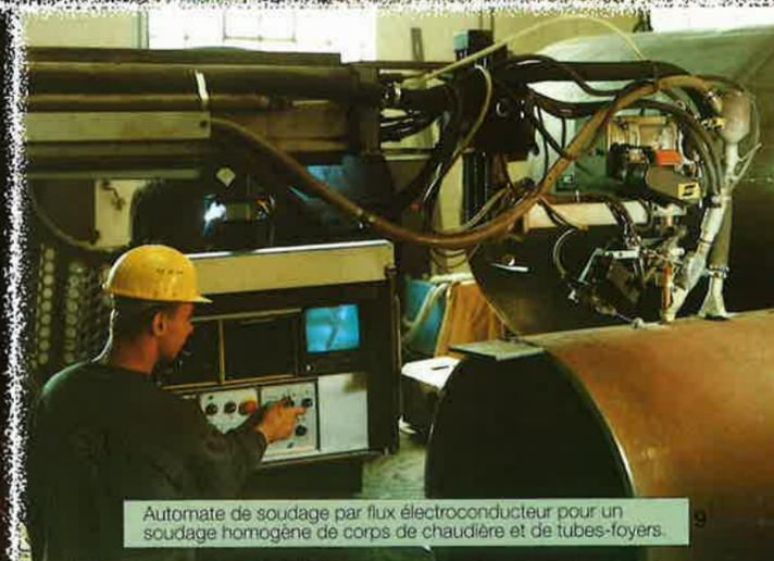
Automate de soudage par flux électroconducteur pour un soudage homogène de corps de chaudière et de tubes-foyers.
