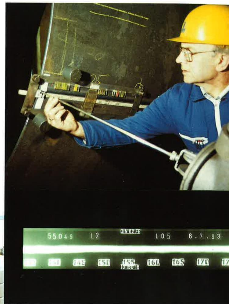
Une soudure longitudinale de virole est contrôlée par ultrasons. L'homogénéité de la virole ne doit pas être interrompue par cette soudure. Les radiographies confirment la bonne exécution de la soudure.
